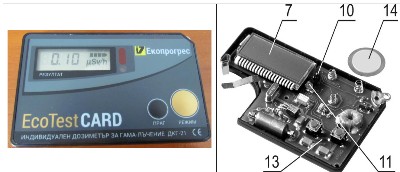
Рисунка Б.1 - Вид на дозиметъра отпред и със свален горен капак
